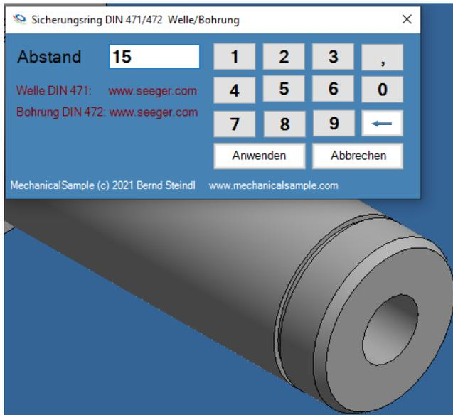
Beim Auswählen des „Sicherungsring Button“ öffnet sich ein weiterer Dialog, um den Einstich für ein Sicherungsring zu erzeugen. Sicherungsringe können nur auf ganzzahligen Durchmessern erzeugt werden. Auf dem Dialog befinden sich Direktlinks mit technischen Grundlagen zu Einstichen nach DIN 471 und DIN 472. Die Webseiten werden in Ihrem Standardbrowser geöffnet.
