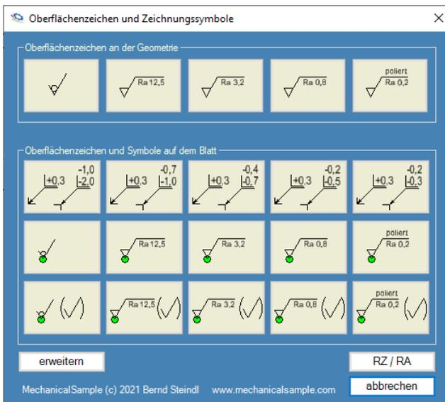
Der Dialog lässt sich von RA auf RZ umstellen. Beim Einfügen an einer Bemaßung erkennt das Tool eine Linearbemaßung und erzeugt das Symbol an beiden Maßlinien gleichzeitig. Das Tool bietet auch ein schnelles Einfügen von Kantenbruchsymbolen nach DIN ISO.
