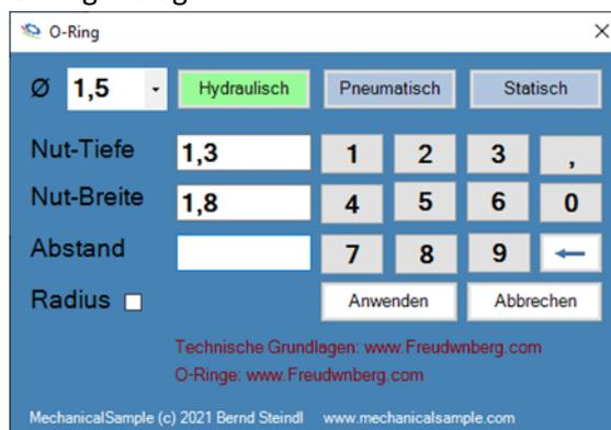
Beim Auswählen des „O-Ring Button“ öffnet sich ein weiterer Dialog, um die Abmessungen der O-Ring Nut zu spezifizieren. Schnurdicke, hydraulisch, pneumatisch und statisch sowie der Abstand von der gewählten planaren Startfläche muss ausgewählt werden. Auf dem Dialog befinden sich Direktlinks mit technischen Grundlagen zu O-Ring Einstichen. Die Webseiten werden in Ihrem Standardbrowser geöffnet.
