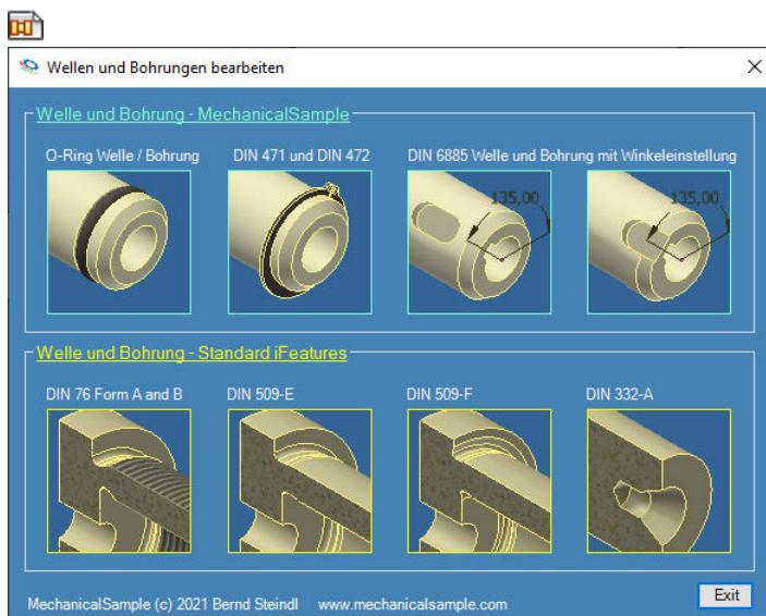
Con questo utensile, è possibile realizzare le cavità per O-ring e anelli di sicurezza in pezzi a simmetria di rotazione o in fori di cuboidi. È possibile richiamare direttamente le iFeatures collaudate per i sottosquadri dei filetti e i sottosquadri dei pezzi torniti. Quando si avvia un'iFeature, i piani di lavoro per la selezione vengono automaticamente attivati e disattivati al termine dell'iFeature.
