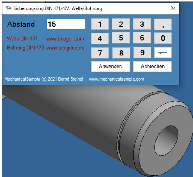
Al seleccionar el botón "Anillo de retención", se abre otro cuadro de diálogo para crear el hueco para un anillo de retención. Los anillos de retención solo se pueden crear con diámetros enteros. El cuadro de diálogo contiene enlaces directos a información técnica sobre huecos según las normas DIN 471 y DIN 472. Las páginas web se abrirán en su navegador predeterminado.
