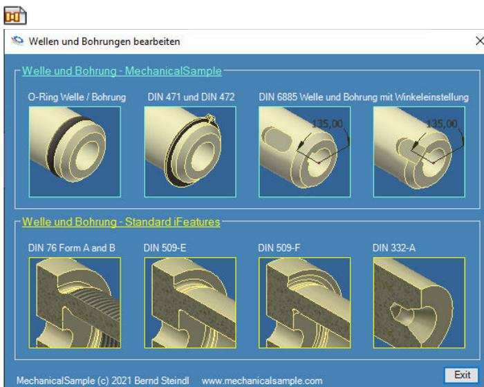
Esta herramienta permite crear ranuras para juntas tóricas y anillos de retención en piezas rotacionalmente simétricas o en agujeros de ortopedros. Se pueden llamar directamente iFeatures de eficacia probada para entalladuras de rosca y entalladuras en piezas torneadas. Al iniciar una iFeature, los planos de trabajo de la selección se activan y desactivan automáticamente al cerrarla. También permite insertar chavetas paralelas, anillos de retención y ranuras para juntas tóricas.
