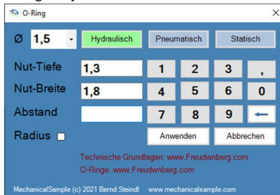
Al seleccionar el botón "Junta tórica", se abre otro cuadro de diálogo para especificar las dimensiones de la ranura. Debe seleccionar el calibre del cable (hidráulico, neumático y estático), así como la distancia desde la superficie inicial plana seleccionada. El cuadro de diálogo contiene enlaces directos a información técnica sobre ranuras para juntas tóricas. Las páginas web se abrirán en su navegador predeterminado.
